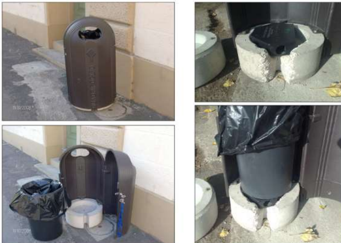
Immagine 11. Esempio di postazione di controllo roditori con erogatore di esca (Autore: Quadrifoglio spa).
