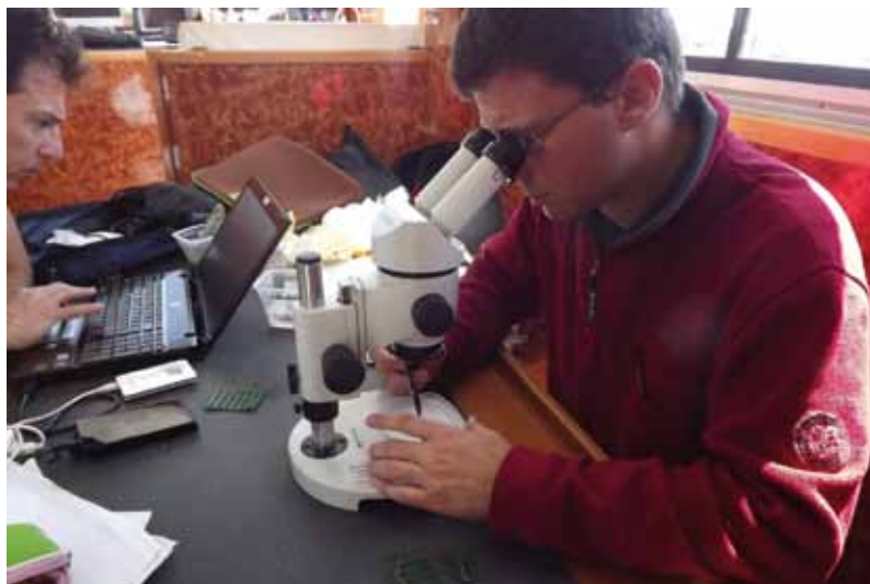
Figura 7. Osservazione allo stereomicroscopio dei quadrati pretagliati di rete dei collettori per la stima delle capsule ovigere deposte e il numero delle uova presenti in esse.
