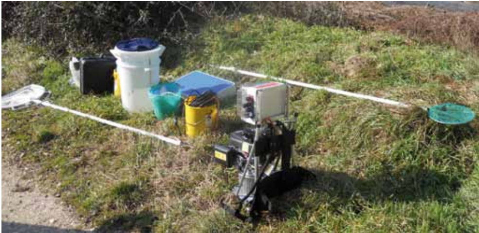
Figura 9.3 Strumentazione necessaria per il campionamento di fauna ittica. Elettrostorditore (compreso di anodo e catodo), guadino, secchi e salopette da pesca modello Wader.
