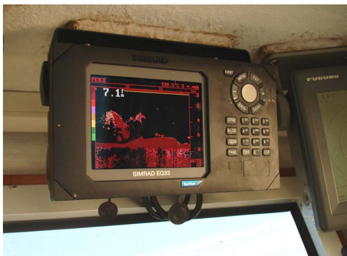
Fig.11. Le campane centrali delle barriere visibili sull'ecoscandaglio.
