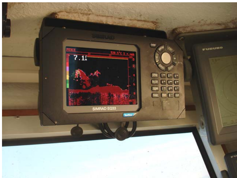
Fig.16. Le campane centrali delle barriere visibili sull'ecoscandaglio.
