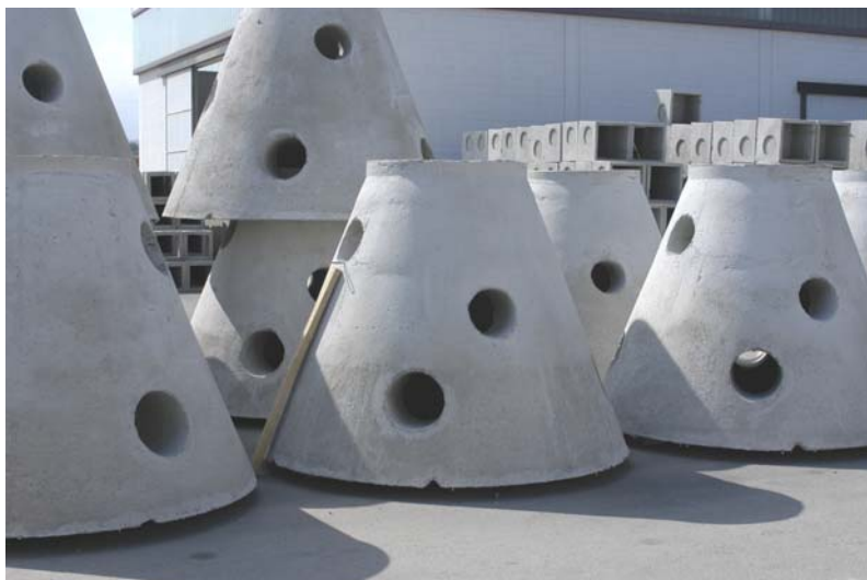
Fig.17. Le campane utilizzate nelle barriere.
