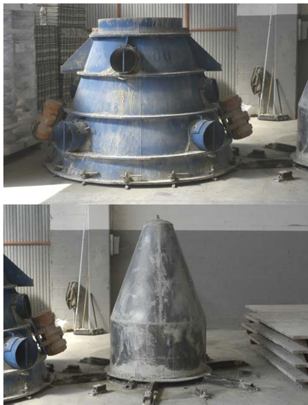
Fig.19. Casseforme per la realizzazione delle campane in calcestruzzo.
