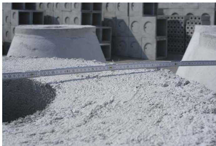
Fig.17. Dettaglio di una campana in calcestruzzo a mostrare la superficie scabra ed il foro centrale.
