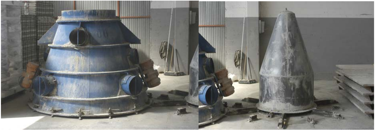
Fig.20. Casseforme per la realizzazione delle campane in calcestruzzo.
