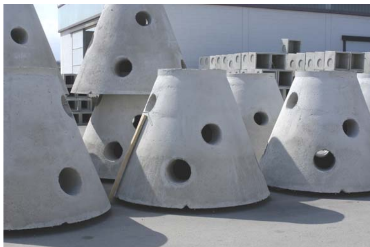
Fig.17. Le campane utilizzate nelle barriere.
