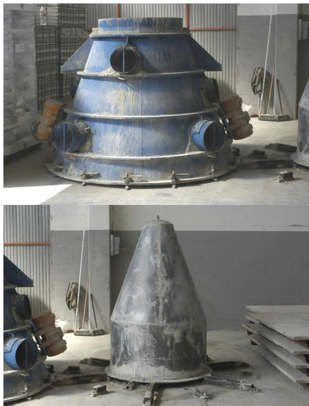
Fig. 20. Casseforme per la realizzazione delle campane in calcestruzzo.
