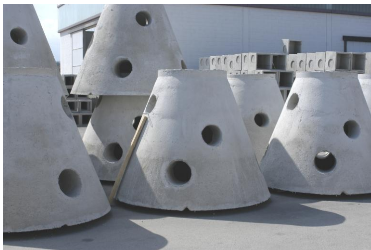
Fig.17. Le campane utilizzate nelle barriere.
