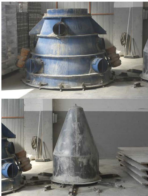
Fig.20. Casseforme per la realizzazione delle campane in calcestruzzo.
