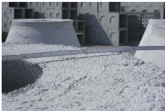
Fig.18. Dettaglio di una campana in calcestruzzo a mostrare la superficie scabra ed il foro centrale.
