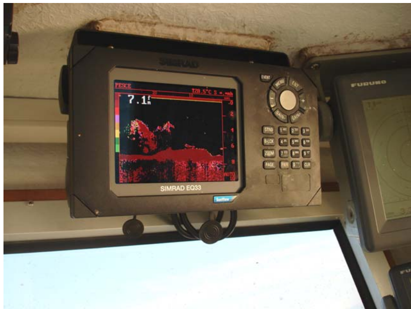
Fig.16. Le campane centrali delle barriere visibili sull'ecoscandaglio.
