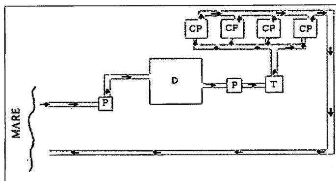
Figura 5.4.3.1 - Schema di impianto a ciclo aperto (tratto e modificato da UNEP-MAP 2003; CP= vasca di convascenza o altro, T= controllo termostatico, P= pompa, F= filtro, D= vasca di decantazione)
