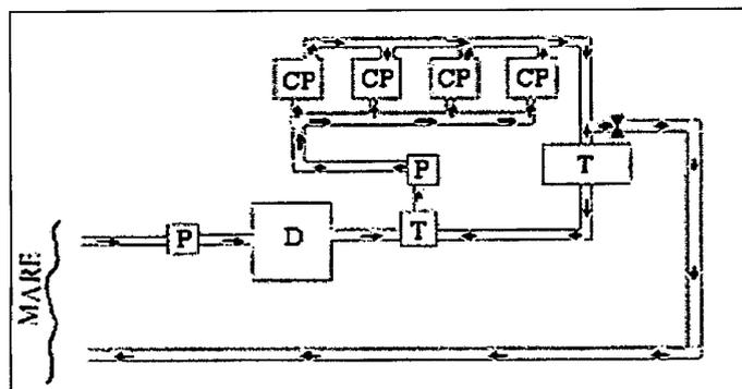
Figura 5.4 - Schema di impianto a ciclo semi aperto (tratto e modificato da UNEP-MAP 2003; CP= vasca di convascenza o altro, T= controllo termostatico, P= pompa, F= filtro, D= vasca di decantazione)
